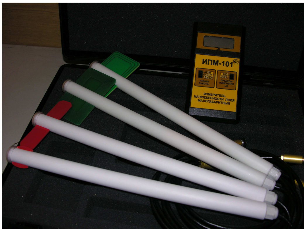
Рис.1 Общий вид измерителя напряженности поля ИМП-101
